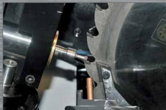
Dispositif pour l'affûtage des dentures à gouge avec mandrin d'haute vitesse jusqu'à 50.000 rpm.
