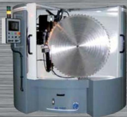
Large ouverture frontale pour faciliter les opérations de chargement / déchargement des lames circulaires de 1200 mm de diamètre.
