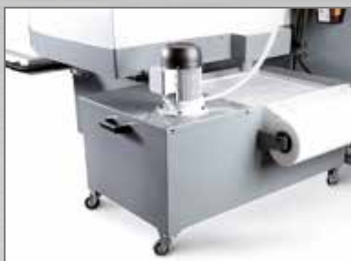
Vasca refrigerante con filtro a carta. Kühlmittel-tank mit Papierbandfilter.
