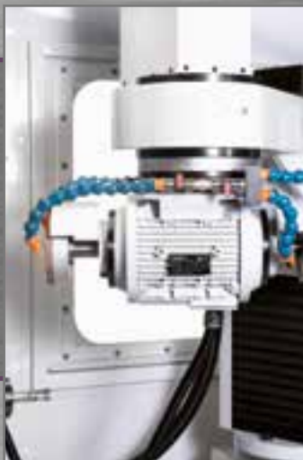
Fantina motorizzata per rettifica cilindrica e affilatura dischi circolari.
