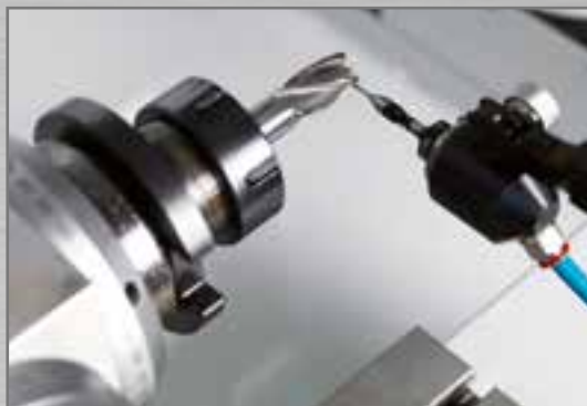
Tastatore per ricerca dell'elica. Taster zur Erfassung der Schraube.
