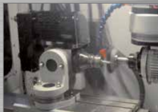
Fantina motorizzata per rettifica cilindrica e affilatura dischi circolari.
